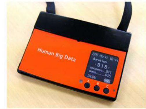
職場での行動データを取得できる、加速度センサー
